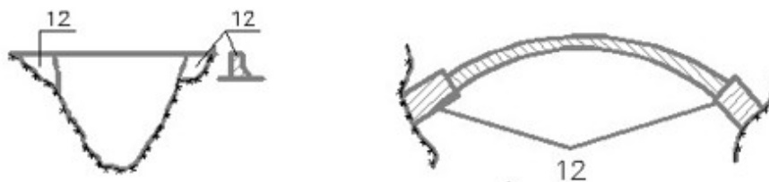
7-сурет – Гравитациялық тірегі бар аркалық бөгеттердің кескінінің схемасы (12 – гравитациялық тіректер)
