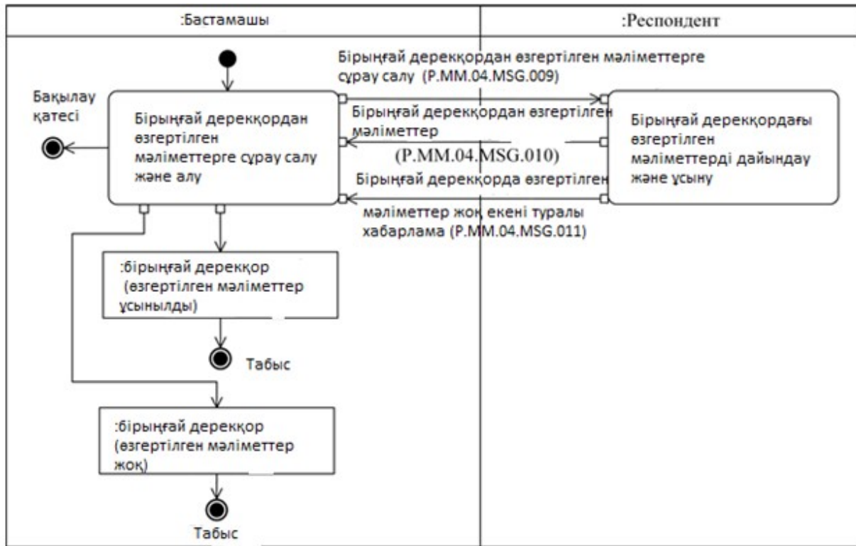
8-сурет. "Бірыңғай дерекқордан өзгертілген мәліметтерді алу" (P.MM.04.TRN.005) жалпы процесс транзакциясын орындау схемасы
