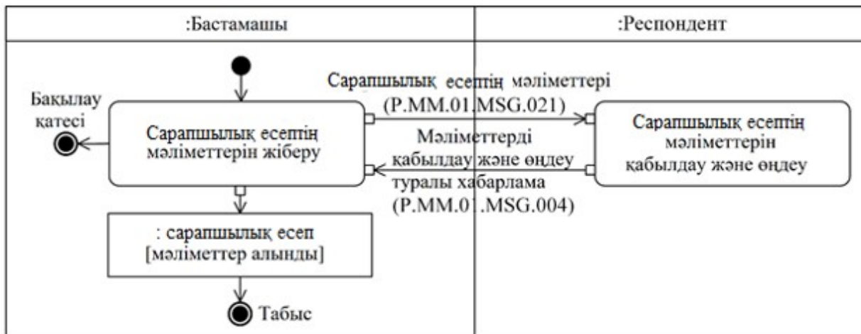
11-сурет. "Сарапшылық есепті алу" жалпы процесінің транзакциясын (P.MM.01.TRN.014) орындау схемасы
