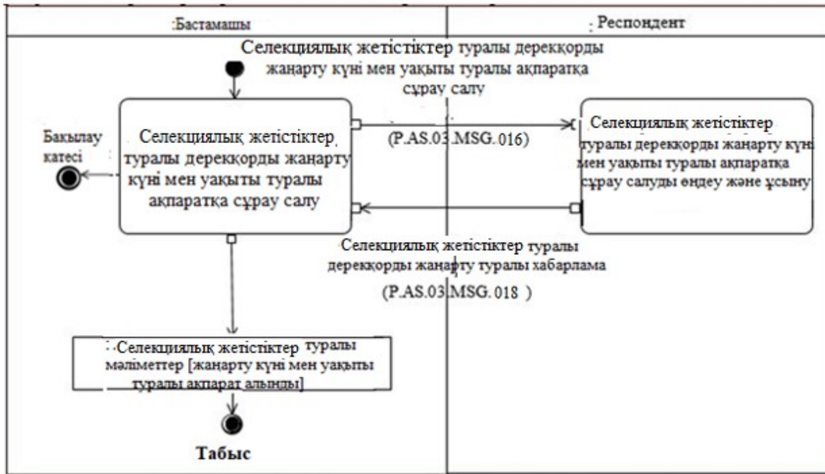
15-сурет. "Селекциялық жетістіктер туралы дерекқорды жаңарту күні мен уақыты туралы ақпарат алу" жалпы процесінің транзакциясы (P.AS.03.TRN.010)
