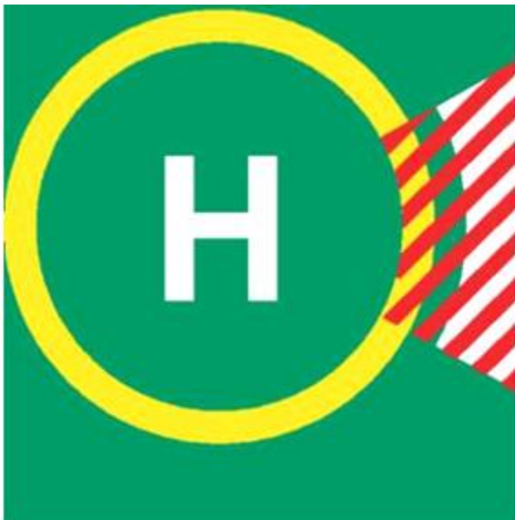
Сурет. Тікұшақпалубасының қонуға тыйым салынған секторының таңбалауы
