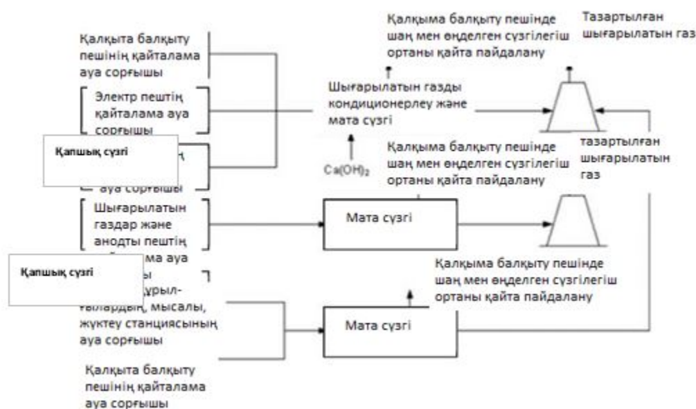
5.8-сурет. Мысты өндеудің бастапқы процесі үшін буды екінші рет жинау жүйесінің схемасы
