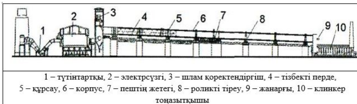
3.30-сурет. Дымкыл тәсілді өндірістің айналмалы пеші
