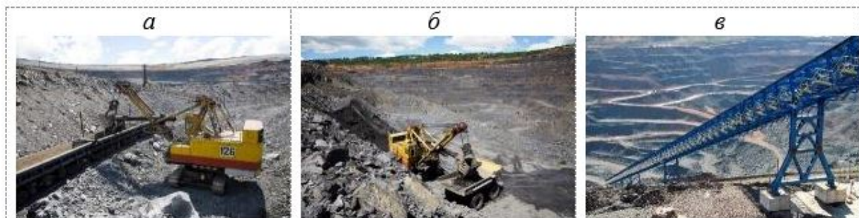
3.6-сурет. а - темір жол, б - автомобиль және в - конвейерлік көліктермен кенді тасымалдау
