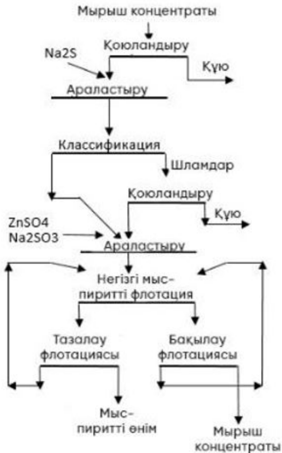
3.30-сурет. Мырыш концентратын мыссыздандыру және темірсіздендіру схемасы
