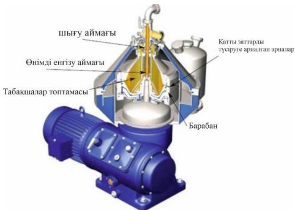
5.4-сурет. Табақшалы центрифуганың технологиялық схемасы
