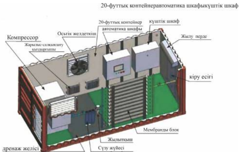
3.40-сурет. МКС жабдығын орналастырудың үлгі схемасы
