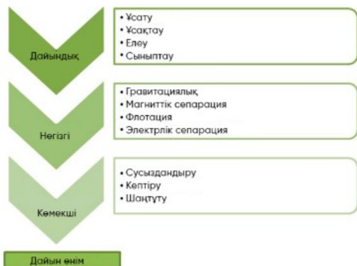
3.24-сурет. Байытудың технологиялық процесінің жалпылама схемасы
