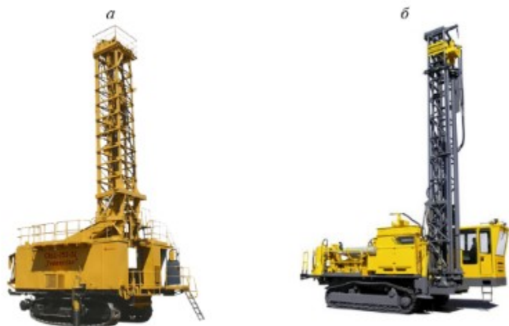
3.6-сурет. Карьерлерде қолданылатын бұрғылау машиналары а - SBSH-250MNA32, б - DM75
