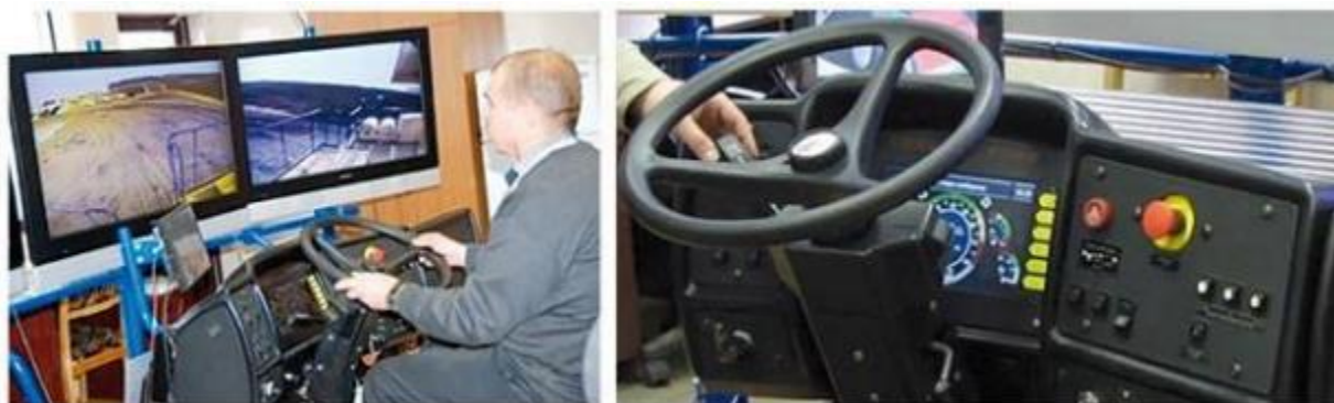
7.3-сурет. Пилотсыз БеЛАЗ операторының кабинасы
