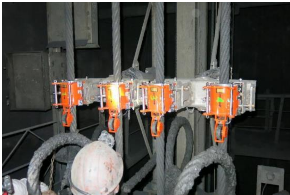
7.10-сурет. Арқанның автоматтандырылған мониторингі жүйесі
