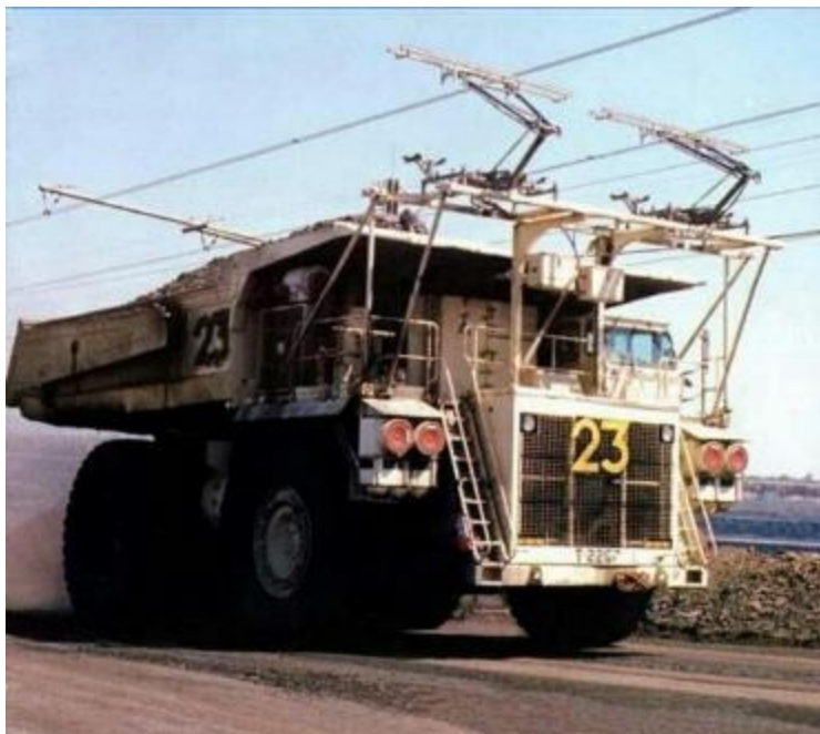
7.4-сурет. Siemens карьерлік самосвалы – троллейвоз
