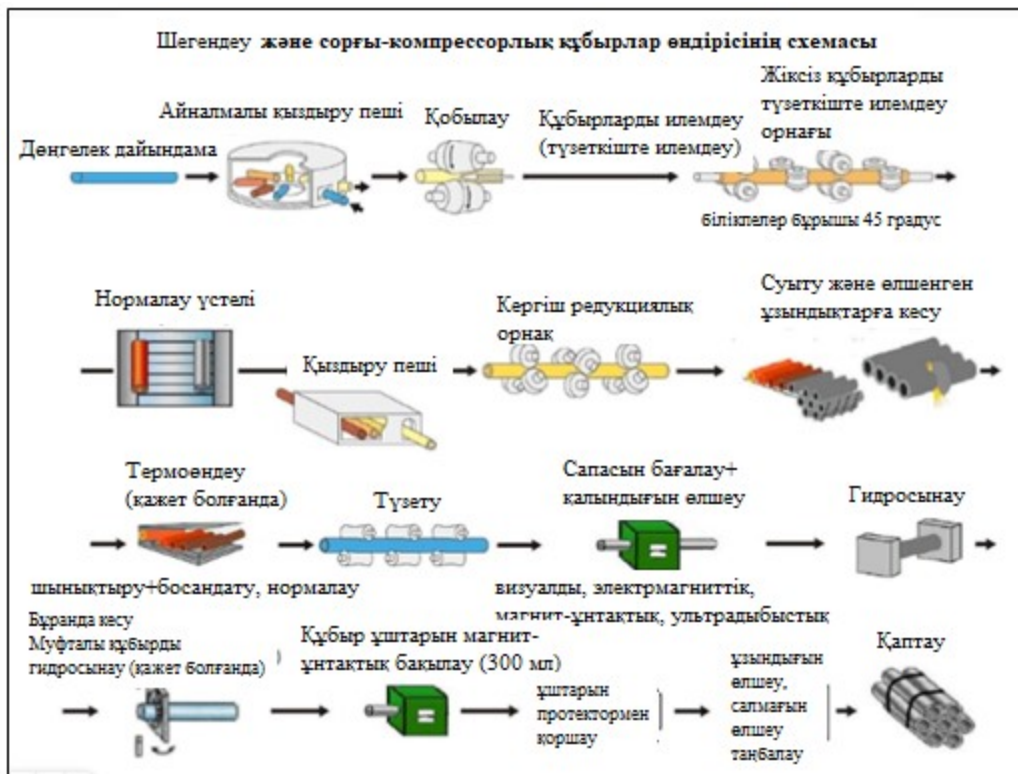
3.16-сурет. Шегендеу және сорғы-компрессорлық құбырларды өндіру схемасы
