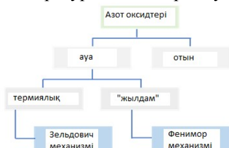
4.17-сурет. Азот оксидтерінің түзілу көздерінің схемасы
