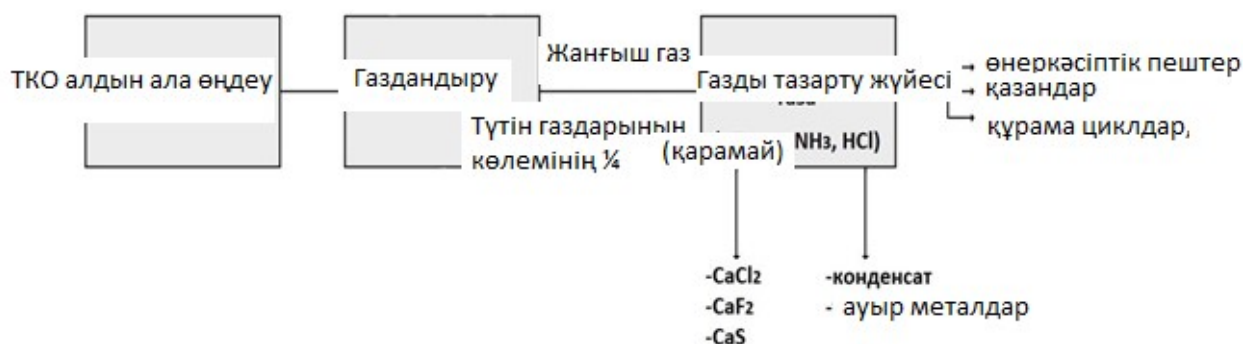
5.51-сурет. ҚКҚ кәдімгі газдандыру процесінің блок-схемасы
