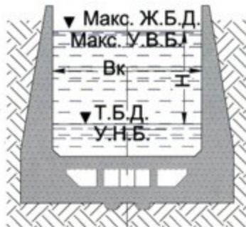
Бір камералық суда жүзетін шлюздың көлденең кесігі Поперечный разрез однокамерного судоходного шлюза
