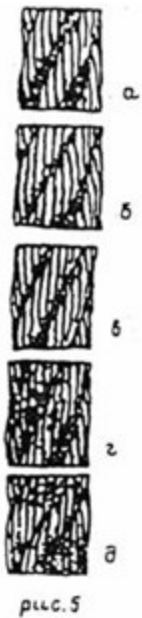
5-сурет. Айқастыра есілген арқандардың сыртқы коррозиясы: а-бетінің бастапқы қышқылдануы; б-бетінің жалпы қышқылдануы; в-айқын қышқылдану; г-қатты қышқылдану; д- қарқынды коррозия 1-кесте
