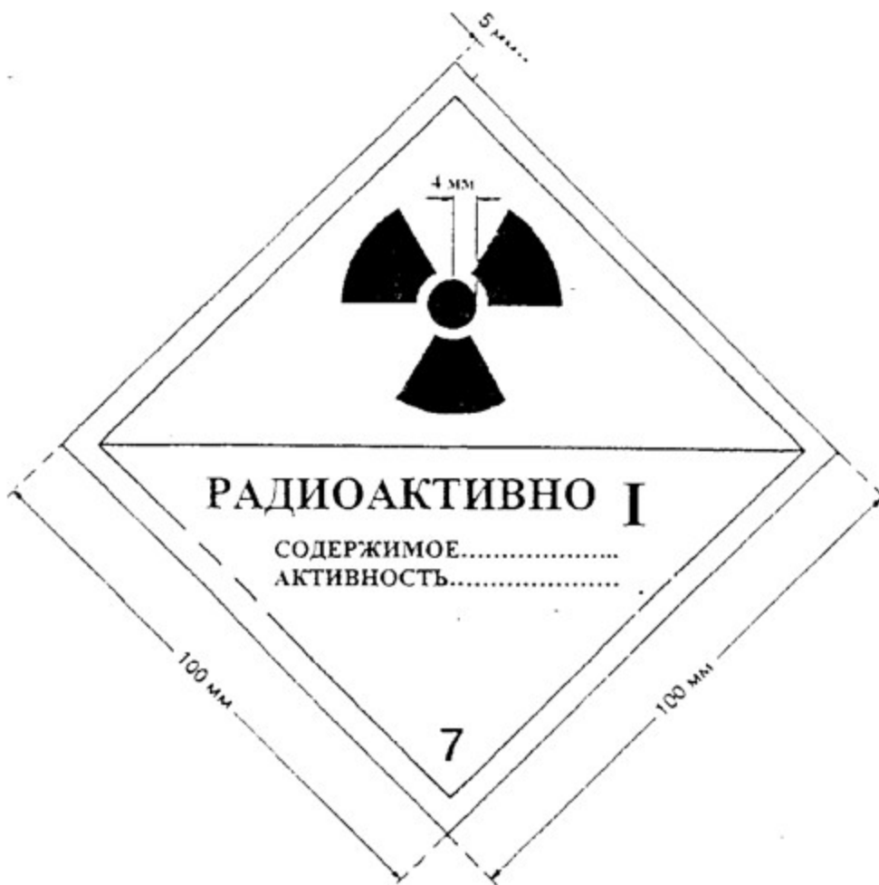
2-сурет. "I-АҚ" санатының этикеткасы. Этикетка фонының түсі - ақ, радиациялық қауіптіліктің (үшқұлақтың) негізгі белгісінің және жазбалардың түсі - қара, санатты белгілейтін жолақтың түсі - қызыл.
