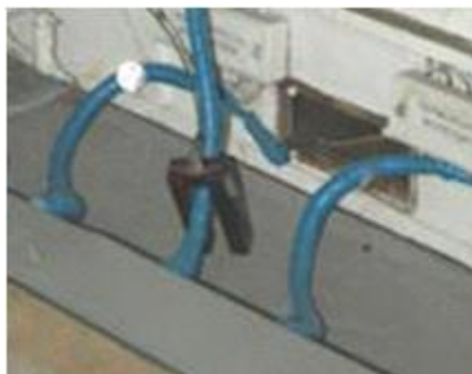
Сурет 1. Ажыратылған өзекшемен "СТ-45" жоғарыжиілікті ток трансформаторы
