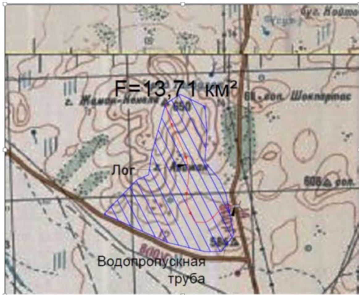
Рисунок А.1 – Площадь водосбора бассейна на а/д Акчатау-Агадырь 166+750 км на топографической карте масштабом 1:200 000
