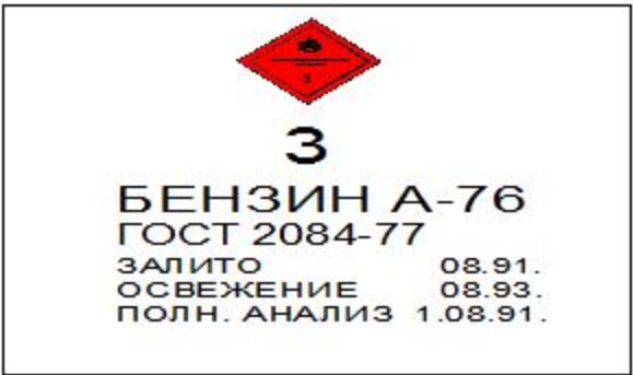
Рис. 6. Пример маркировочной таблицы для резиноканевого резервуара
