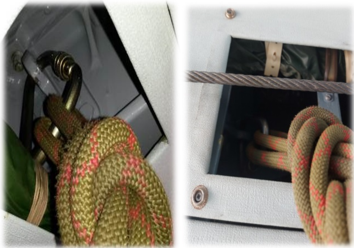
Крепление спускового каната (фалла) в центральный люк
