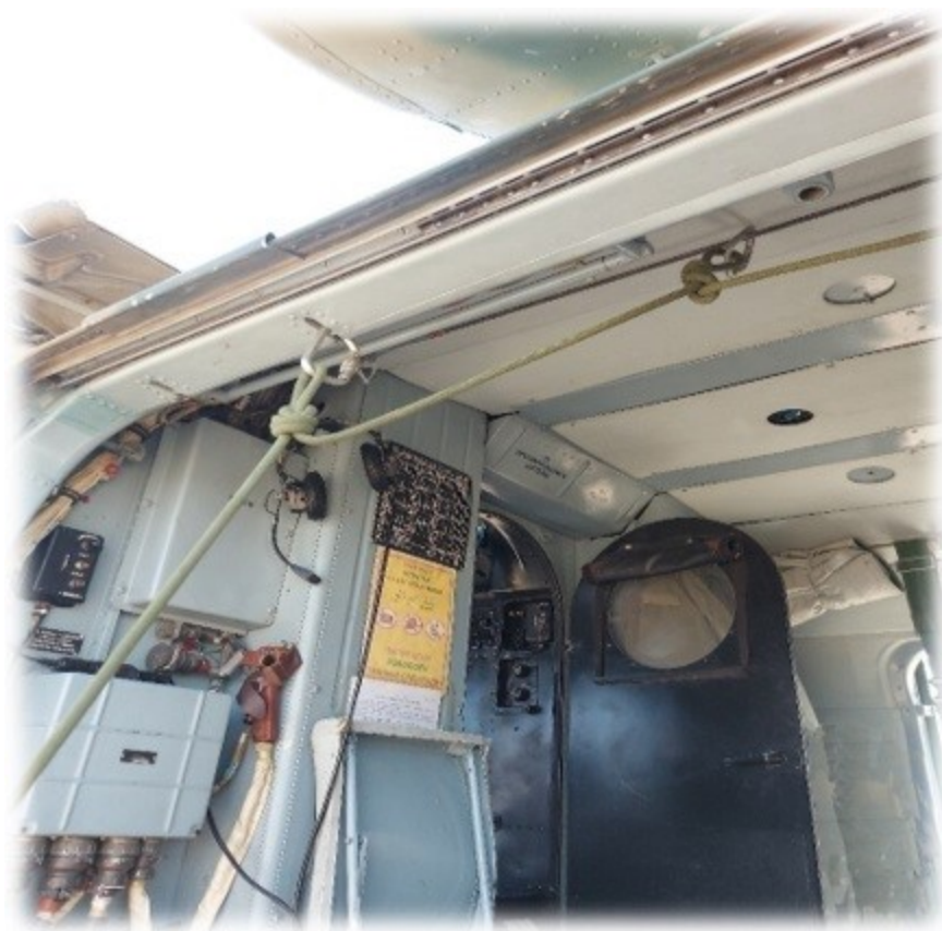
Крепление СС в левом дверном проеме (вид снаружи)
