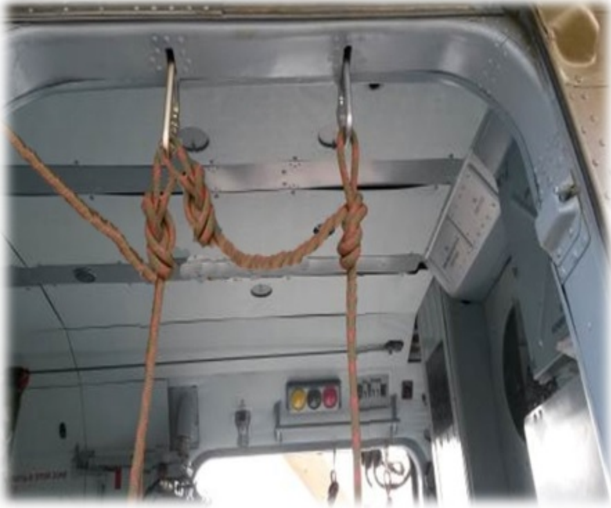
Крепление СС в правом дверном проеме (вид снаружи)
