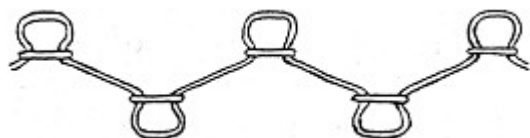
Р и с . 5 Трикотажное полотно переплетения ластик типа 1 лицевая петля x 1 петля, снятая без провязывания
