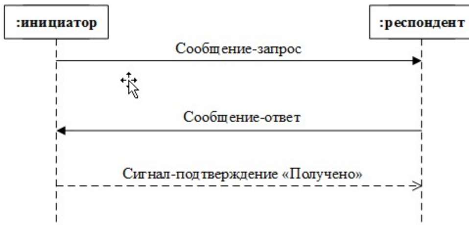
Рис. 5. Последовательность выполнения транзакции общего процесса по шаблону "Запрос/подтверждение" с обеспечением гарантированности доставки
