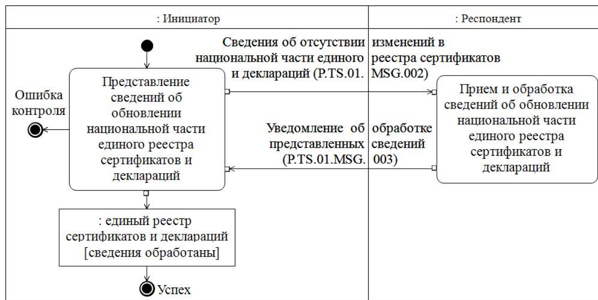
Рис. 4. Схема выполнения транзакции общего процесса "Передача уведомления об отсутствии изменений в национальной части единого реестра сертификатов и деклараций" (P.TS.01.TRN.002)
