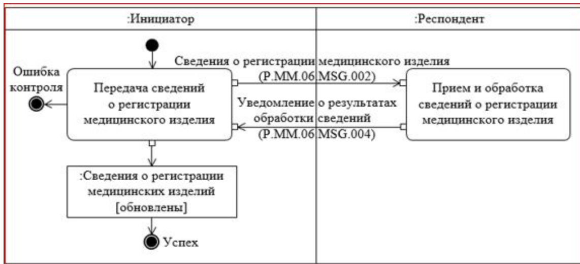
Рис. 5. Схема выполнения транзакции общего процесса "Передача в Комиссию сведений о регистрации медицинского изделия" (P.MM.06.TRN.002)
