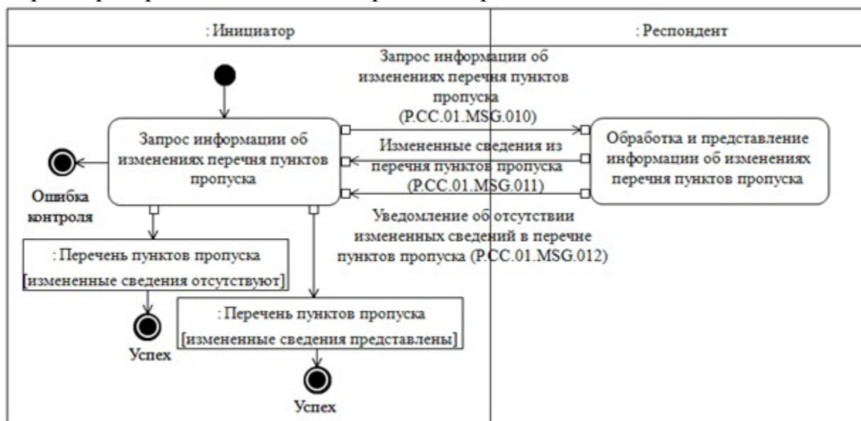
Рис. 9. Схема выполнения транзакции общего процесса «Получение информации об изменениях, внесенных в перечень пунктов пропуска» (P.CC.01.TRN.006)
