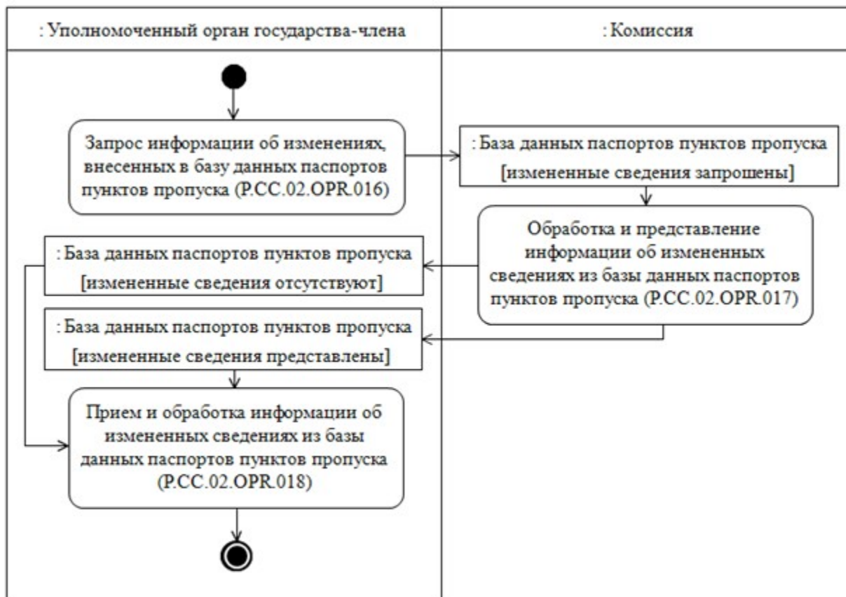
Рис. 9. Схема выполнения процедуры «Получение информации об изменениях, внесенных в базу данных паспортов пунктов пропуска» (P.CC.02.PRC.006)
