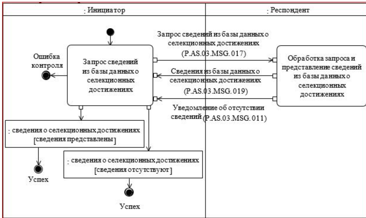
Рис. 16. Схема выполнения транзакции общего процесса "Получение сведений из базы данных о селекционных достижениях" (P.AS.03.TRN.011)
