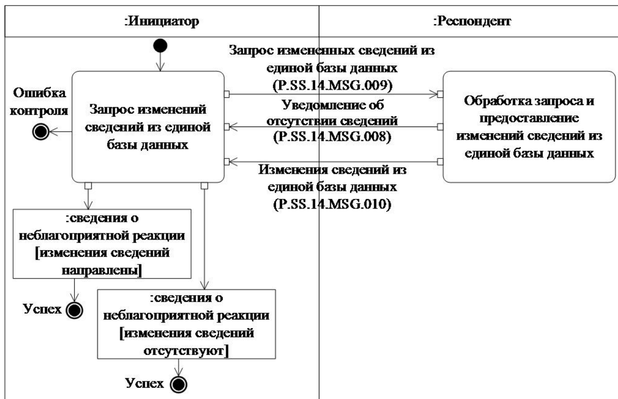
Рис. 8. Схема выполнения транзакции общего процесса "Получение изменений сведений из единой базы данных" (P.SS.14.TRN.005)
