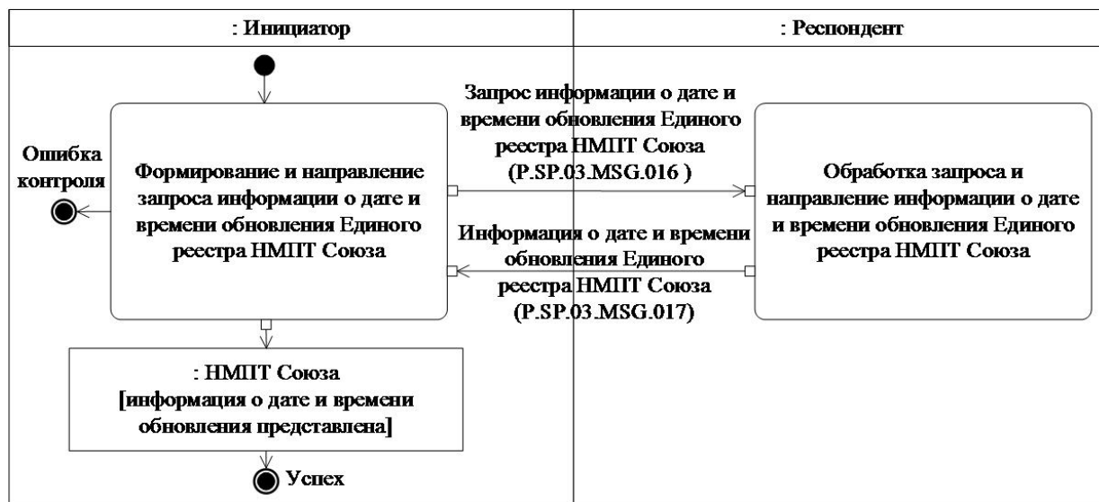
Рис. 12. Схема выполнения транзакции общего процесса "Получение информации о дате и времени последнего обновления Единого реестра НМПТ Союза" (P.SP.03.TRN.008)
