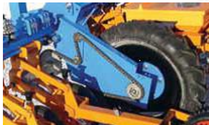
Пример посевной секции Пример конструкции узла центрального привода
