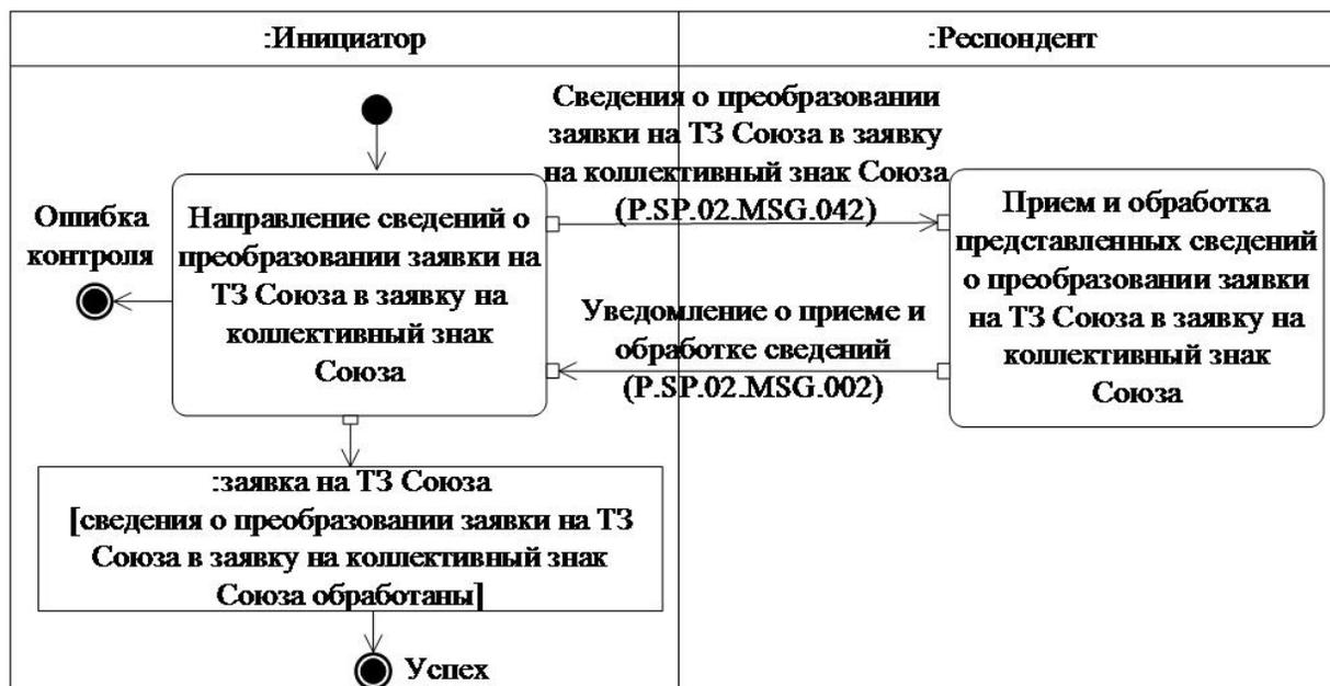
Рис. 24. Схема выполнения транзакции общего процесса "Направление сведений о преобразовании заявки на ТЗ Союза в заявку на коллективный знак Союза" (P.SP.02.TRN.037)
