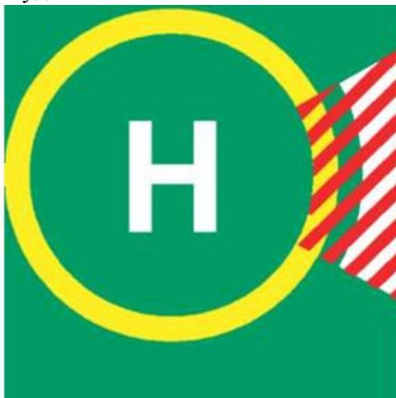
**Рис. Маркировка запрещенного для посадки сектора вертопалубы**
