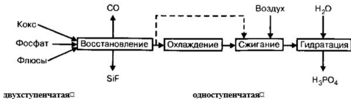
Рисунок 3.6. Технологические схемы производства фосфорной кислоты термическим методом
