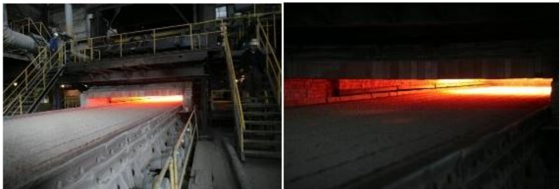
Рисунок 3.2. Процесс спекания агломерата из фосфоритной мелочи
