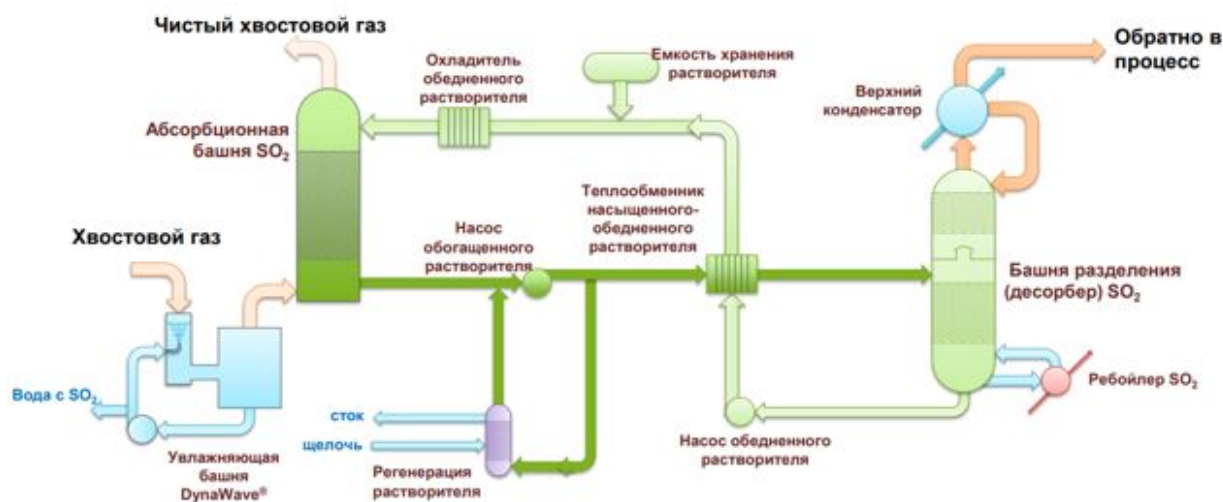
Рисунок 4.3. Процесс регенеративной абсорбции \text{SO}_2 SolvR ®
