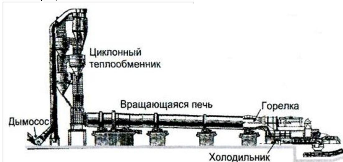
Рисунок 3.32. Печь с циклонным теплообменником
