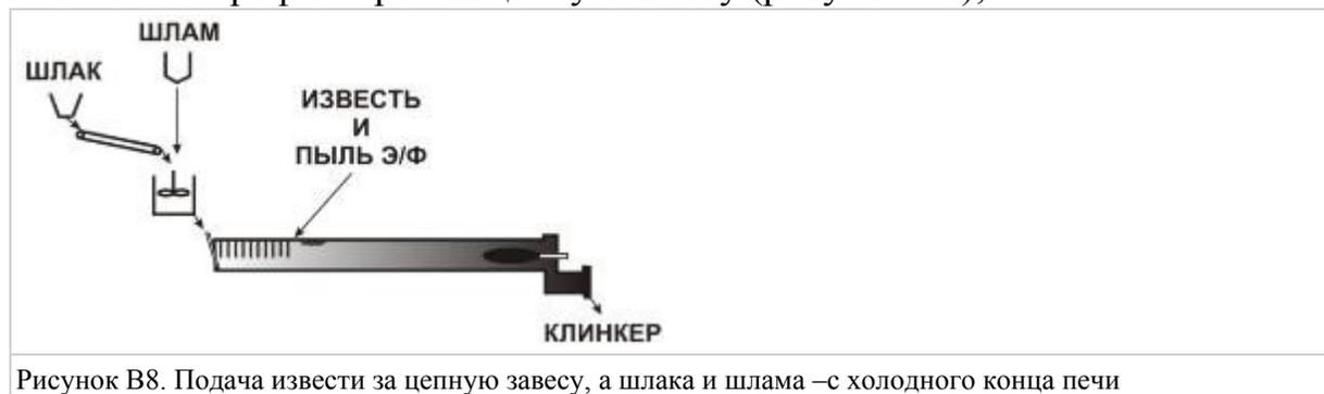
Рисунок В8. Подача извести за цепную завесу, а шлака и шлама — с холодного конца печи
