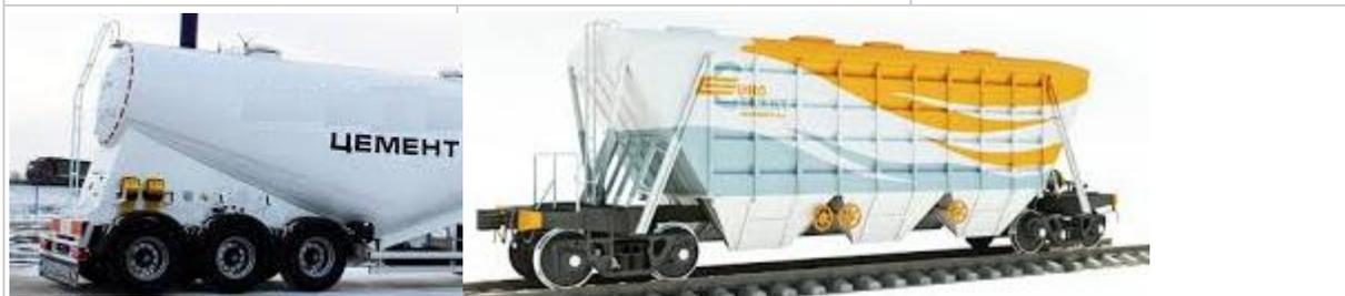
Рисунок 3.44. Автоцементовоз и вагон-хopper для транспортировки цемента
