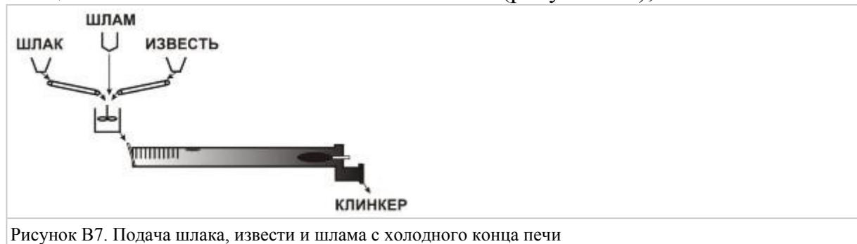
Рисунок В7. Подача шлака, извести и шлама с холодного конца печи
