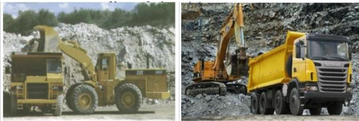
Рисунок 3.8. Погрузка известняка ковшевым погрузчиком и экскаватором
