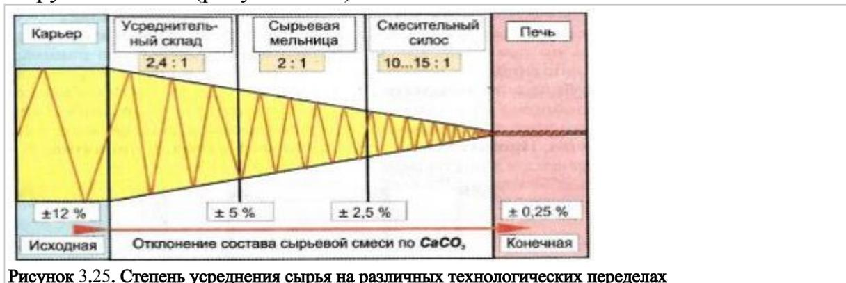
Рисунок 3.25. Степень усреднения сырья на различных технологических переделах
