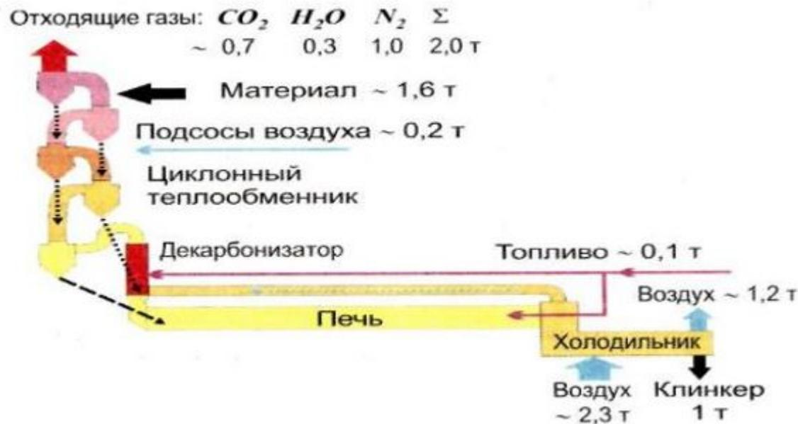
Рисунок 3.4. Материальный баланс печи сухого способа [22]
