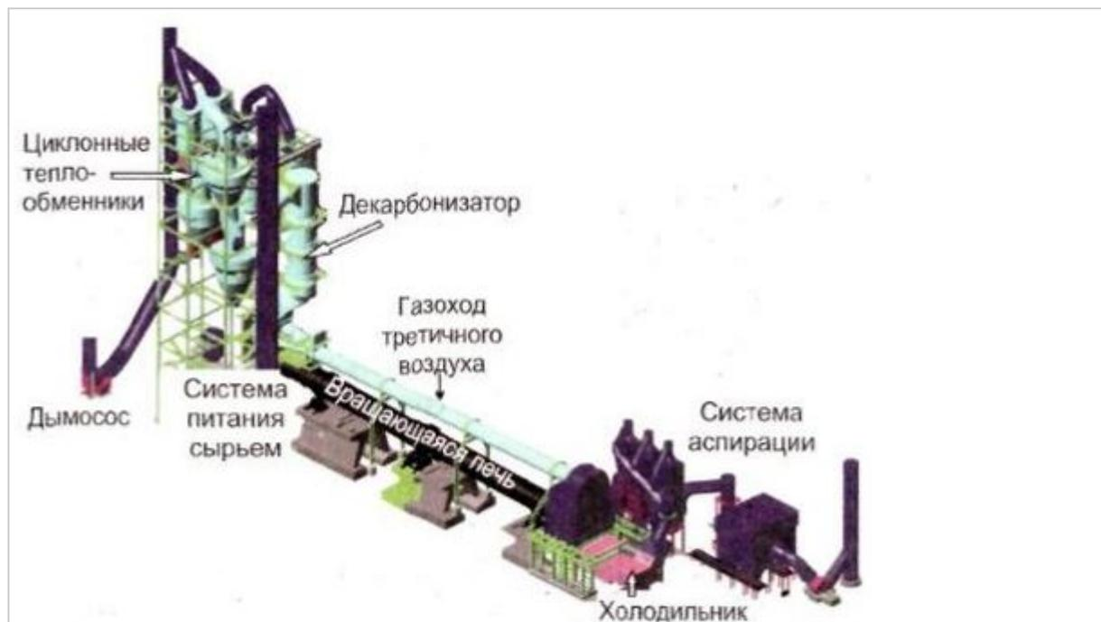
Рисунок 3.34. Современная печь с декарбонизатором
