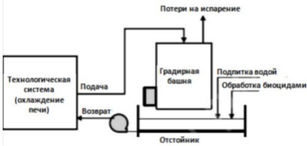
Рисунок .12. Пример рециркуляции охлаждающей воды
