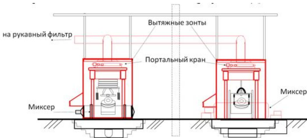
Рисунок .15. Система улавливания "дом-в-доме"
