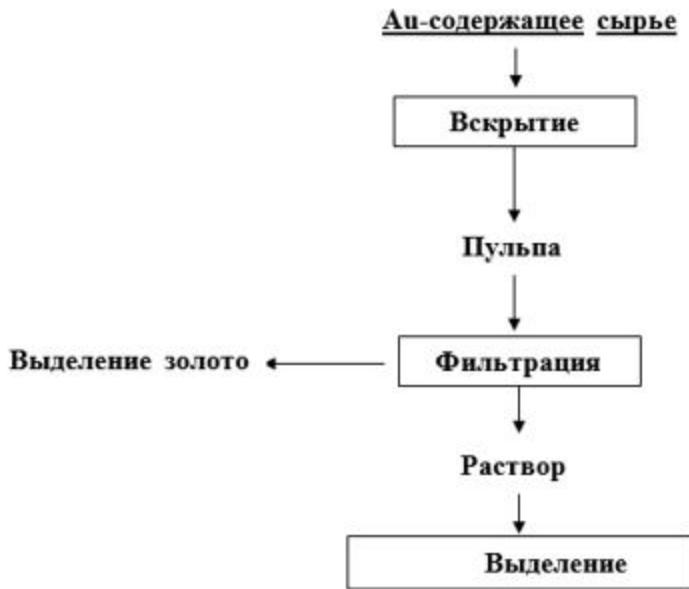
Рисунок .3. Принципиальная схема аффинажа золота
