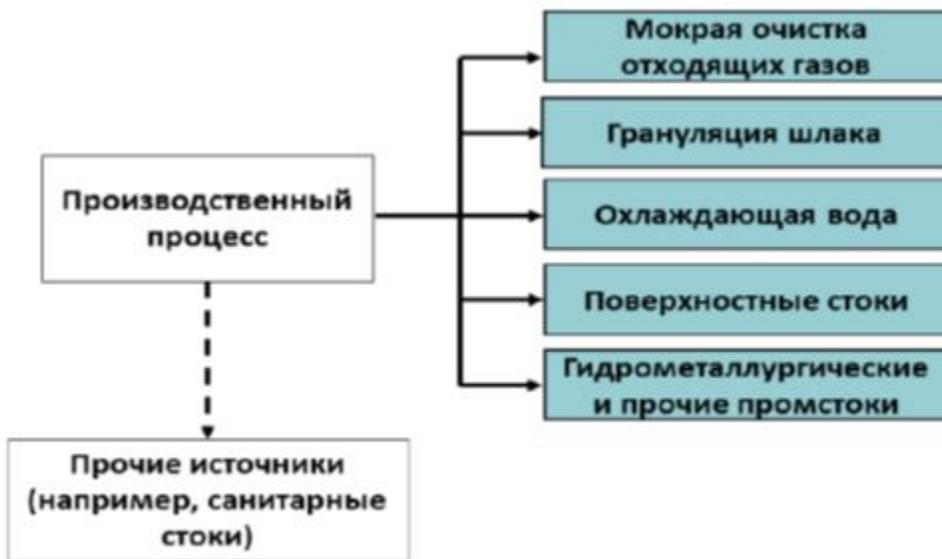
Рисунок .4. Классификация сбросов сточных вод
