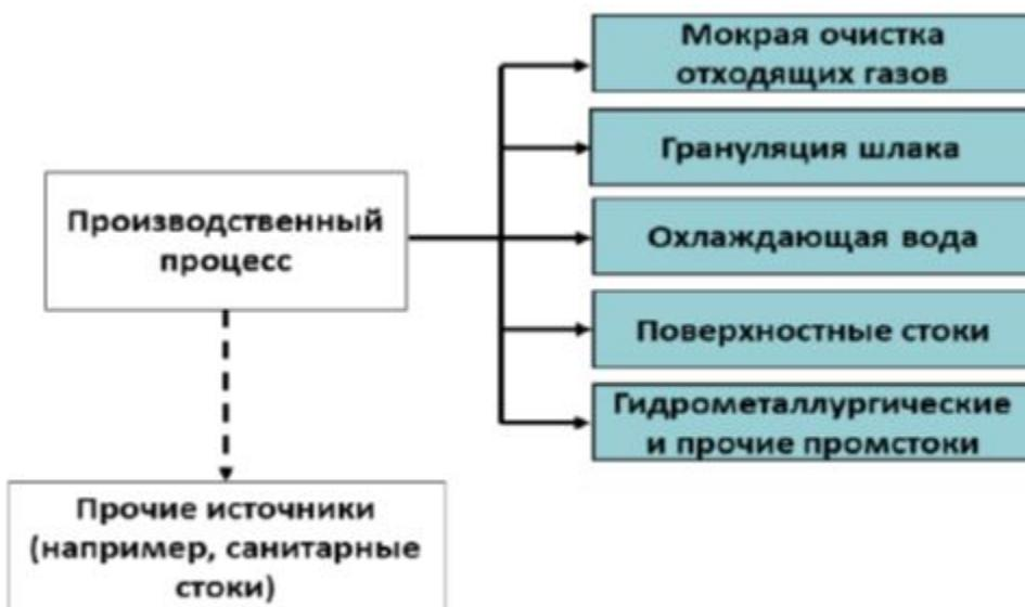
Рисунок .4. Классификация сбросов сточных вод
