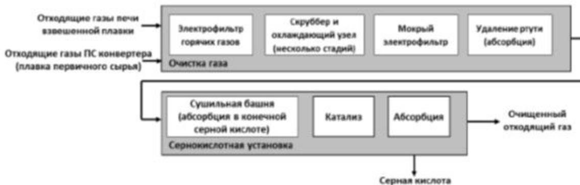
Рисунок .16. Типичная схема газоочистки для сернокислотной установки
