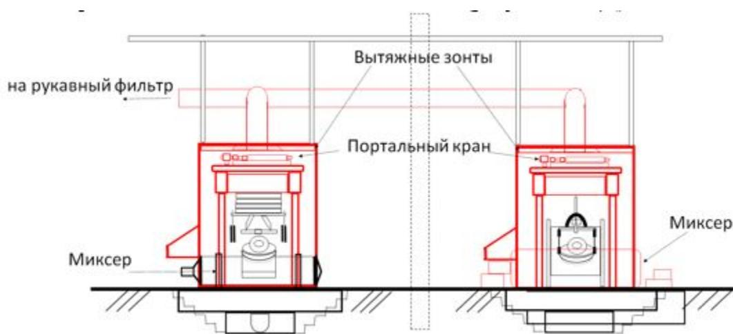
Рисунок .15. Система улавливания "дом-в-доме"
