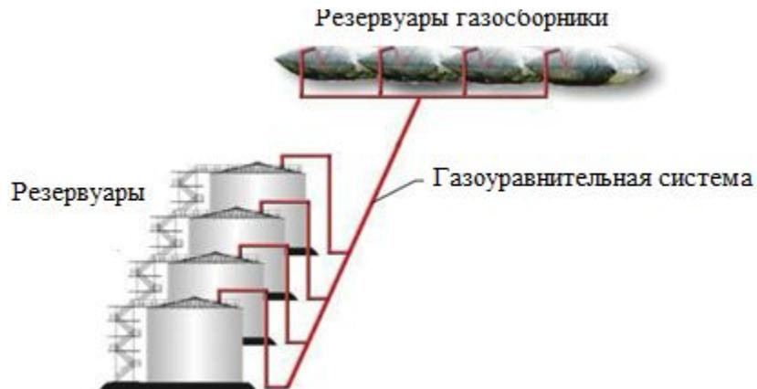
Рисунок .. Газоуравнительная система
