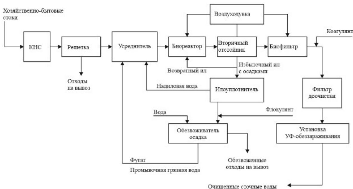
Рисунок .. Схема биологической очистки сточных вод
