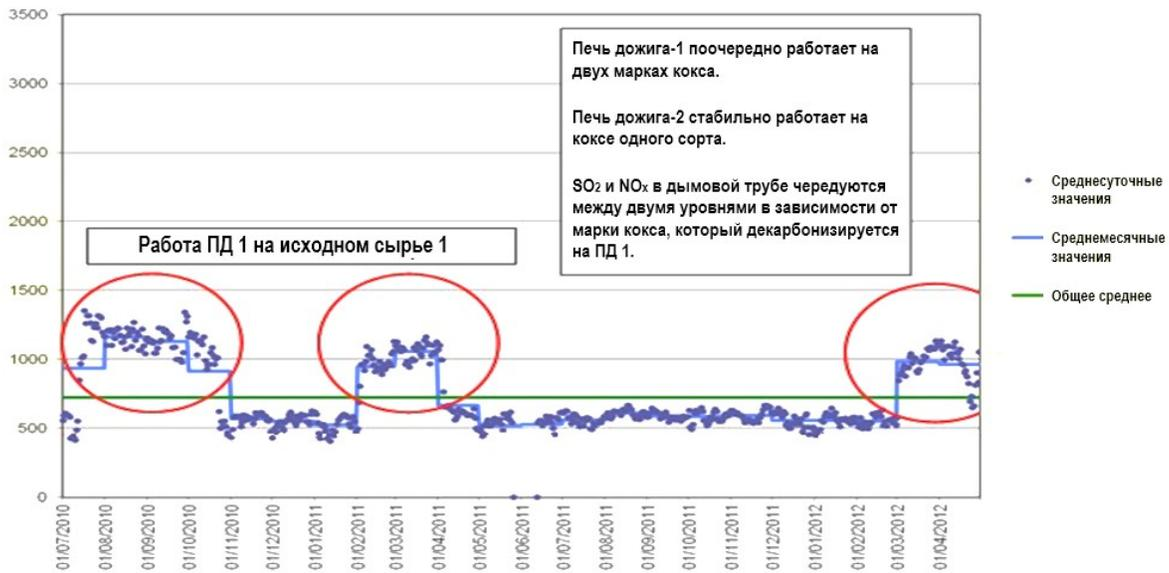
Рисунок .. Вариабельность выбросов в атмосферу SO<sub>2</sub>: Пример двух установок прокалки нефтяного кокса (вращающихся печей) с общей трубой
