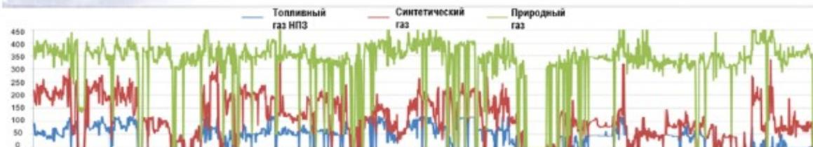
Рисунок .. Суточные вариации выбросов в атмосферу от газовой турбины, использующей три вида топлива (пример с нефтеперерабатывающего завода J-GTA - 170 МВт)
