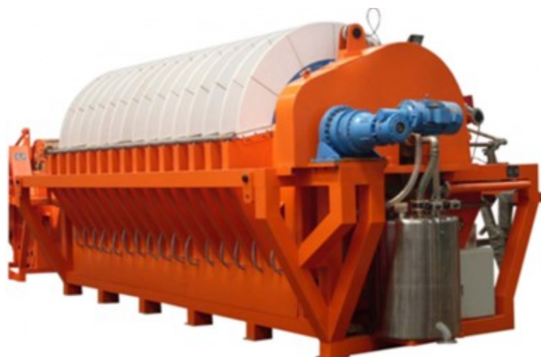
Рисунок 5.8. Керамический дисковый вакуумный фильтр
