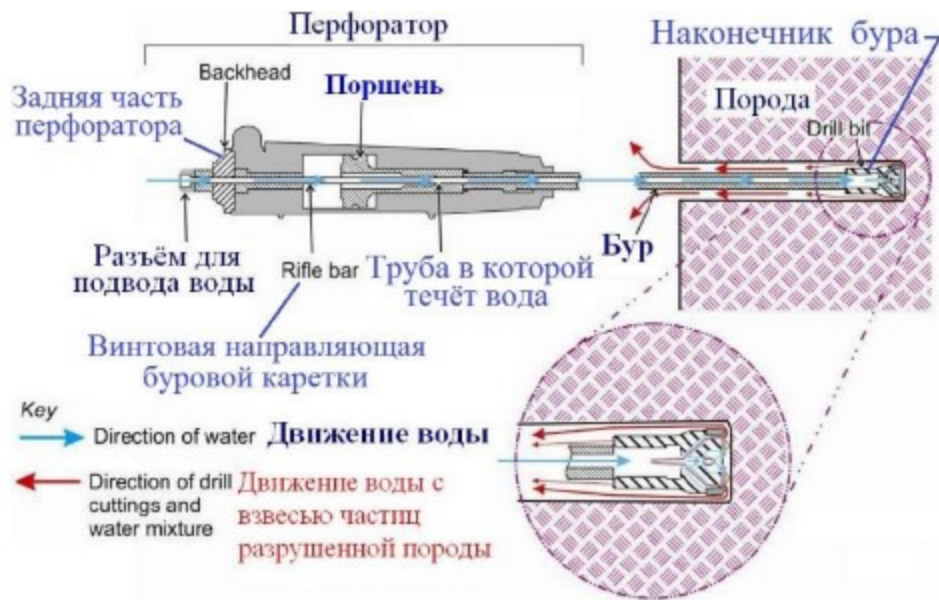
Рисунок .12. Схема движения воды при мокром бурении скважин и шпуров ручными перфораторами
