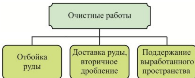
Рисунок 3.12. Классификация комплекса рабочих процессов при производственной стадии очистных работ
