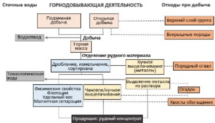
Рисунок 3.1. Схема основных технологических процессов горнодобывающего предприятия [3]
