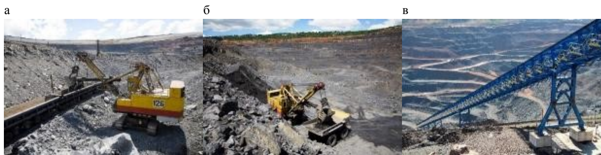
Рисунок 3.6. Транспортировка руды а - железнодорожным, б- автомобильным и в - конвейерным транспортом
