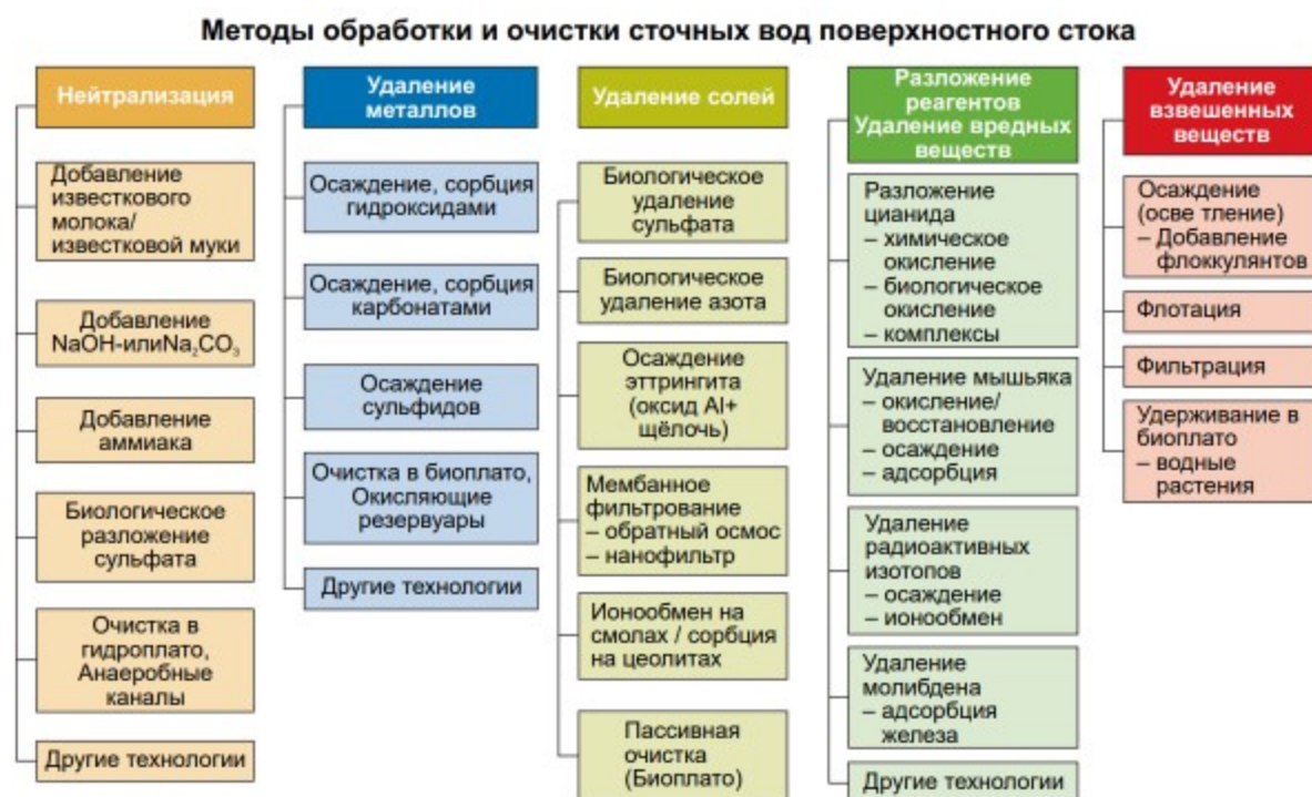
Рисунок 5.22. Методы очистки сточных вод (дополнительная информация INAP 2009, ЕС 2009)
