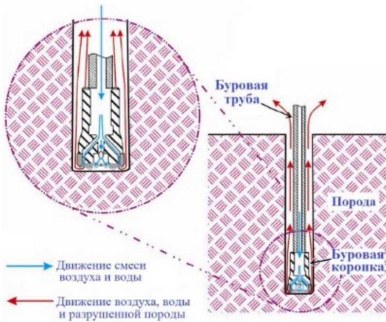
Рисунок .11. Движение воздушно–водяной смеси при мокром методе пылеподавления
