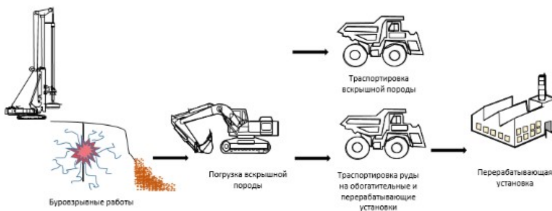
Рисунок 3.2. Схема технологического процесса открытых горных работ
