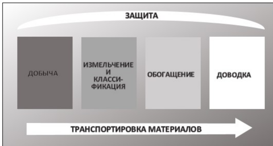
Рисунок 3.20. Схема технологического этапа переработки руд
