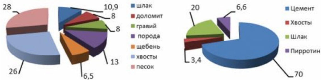
Рисунок 5.25. Диаграмма использования вяжущих (а) и инертных материалов (б) в закладочных работах (%)
