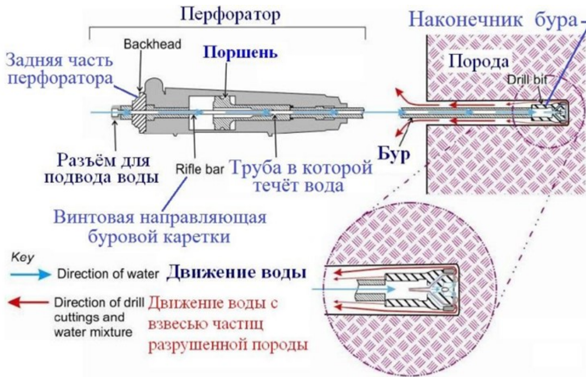
Рисунок 5.4. Схема движения воды при мокром бурении скважин и шпуров ручными перфораторами
