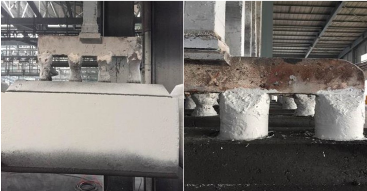
Рисунок 7.3. Анод и ниппеля с нанесенным покрытием
