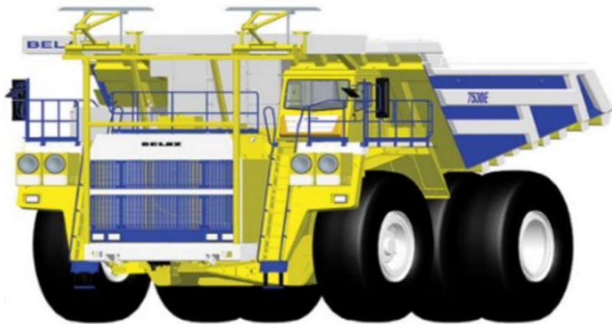
Рисунок 7.6. 3D-проект дизель-троллейвоза БелАЗ
