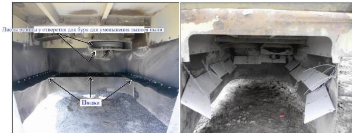
Рисунок 5.20. Отклоняющие пылевой поток полки в ограждении
