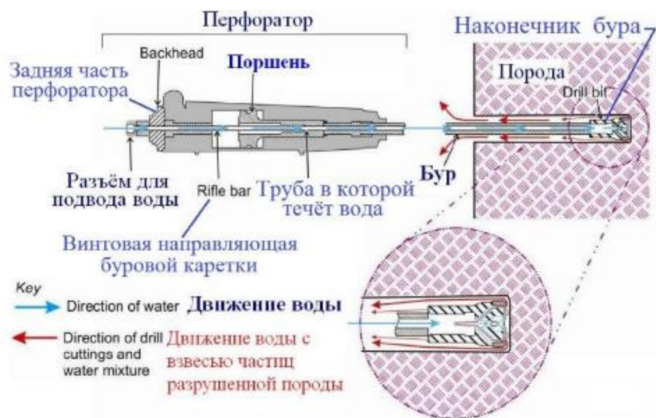
Рисунок 5.17. Схема движения воды при мокром бурении скважин и шпуров ручными перфораторами
