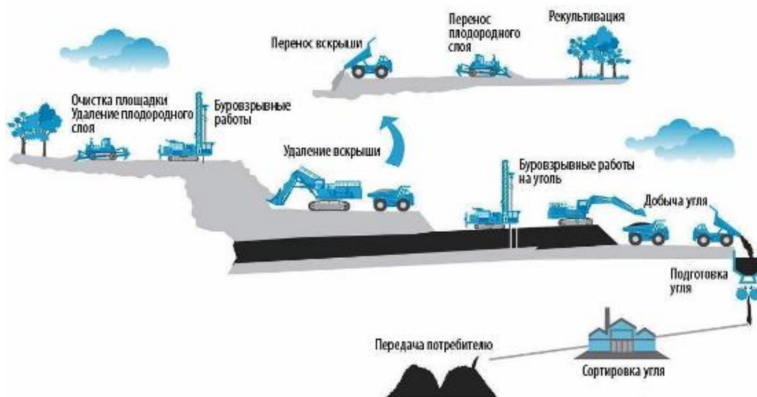
Рисунок 3.1. Общая схема технологического процесса при добыче угля открытым способом.
