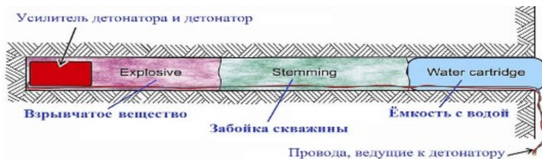
Рисунок 5.24. Типичная скважина, подготовленная к проведению взрыва
