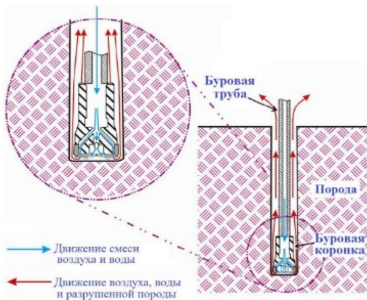
Рисунок 5.16. Движение воздушно-водяной смеси при мокром методе пылеподавления
