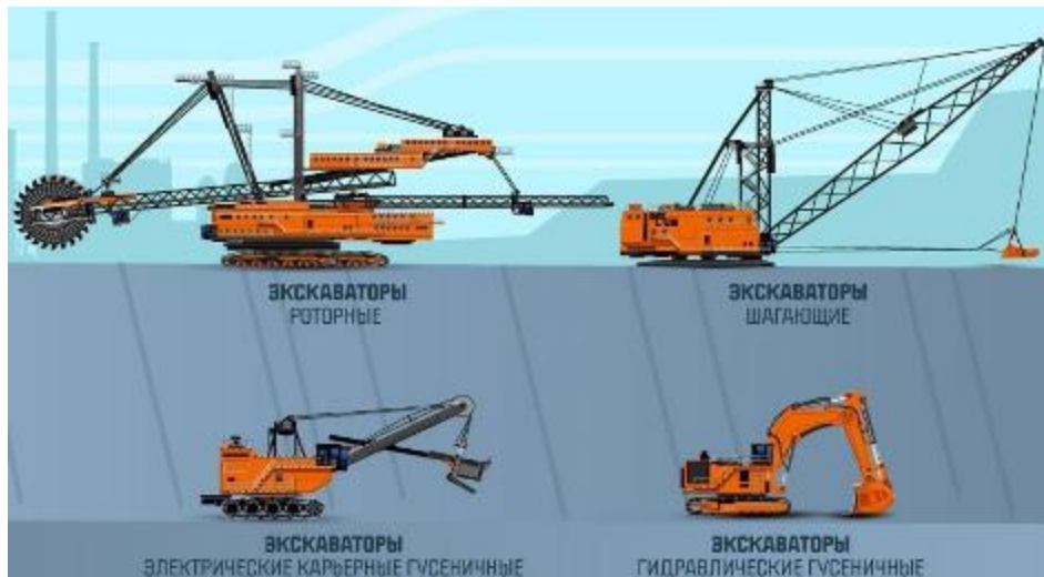
Рисунок 3.3. Виды экскаваторов, применяемых на открытых горных разработках
