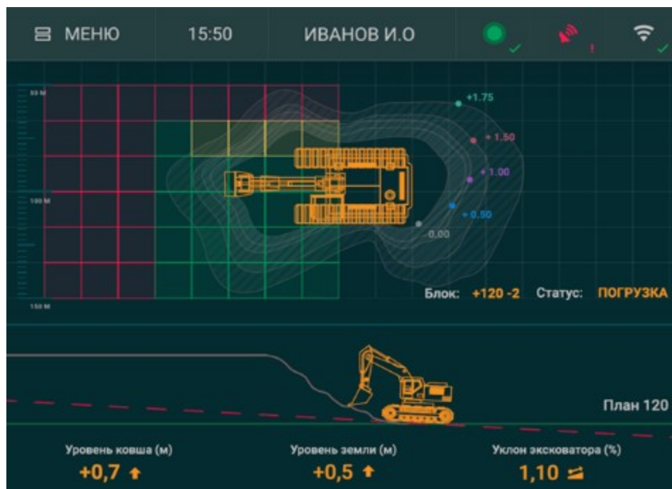
Рисунок 7.8. Схема автоматизированной системы высокоточного позиционирования ковша экскаватора
