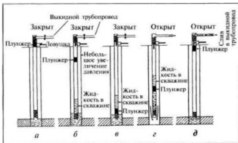
Рисунок 3.5. Цикл работы плунжерного подъемника:
