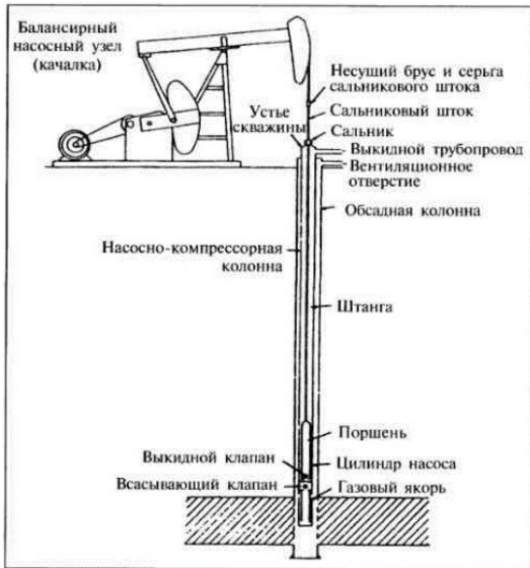
Рисунок 3.6. Наиболее распространенный тип штангового насоса
