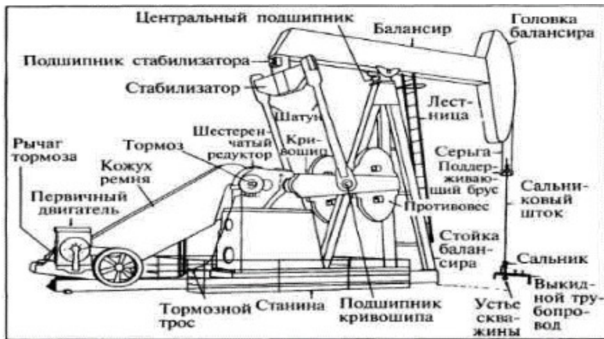
Рисунок 3.10. Схематический рисунок станка-качалки
