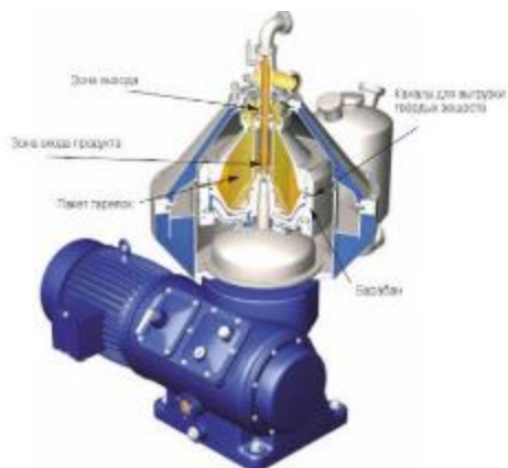
Рисунок 5.4. Технологическая схема тарельчатой центрифуги
