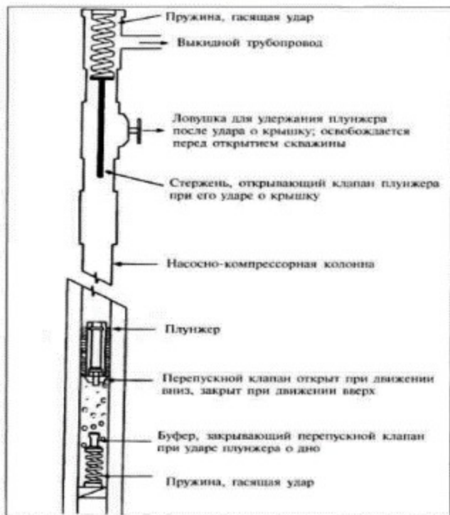
Рисунок 3.4. Основные части плунжерного подъемника
