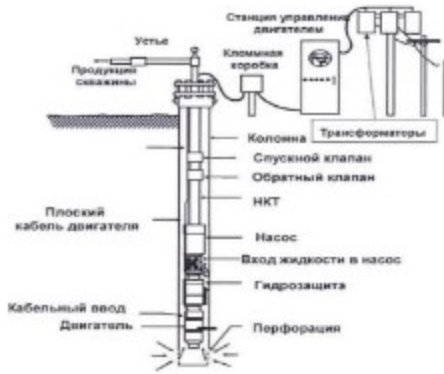
Рисунок 3.13. Принципиальная схема электроцентробежного насоса
