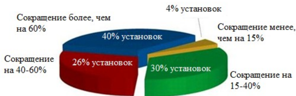
Рисунок 5.19. Результаты сокращения концентрации NOX из-за применения присадок на установках
