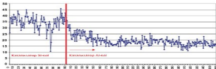
Рисунок 5.17. Влияние выбора катализатора, нестойкого к истиранию, на выбросы взвешенных частиц (мг/Нм 3 ) через 100 дней
