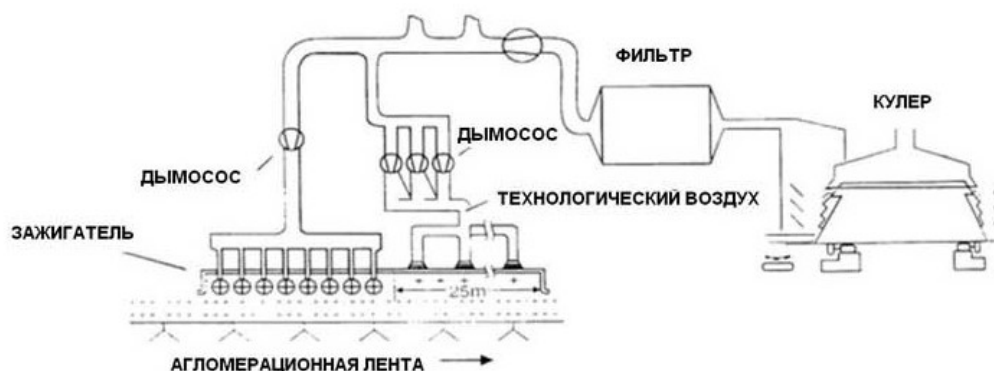
Рисунок 5.3. Рекуперация тепла воздуха, используемого при охлаждении агломерата
