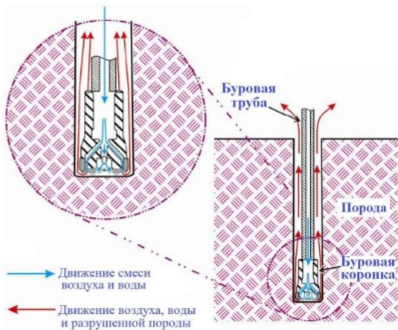
Рисунок .. Движение воздушно–водяной смеси при мокром методе пылеподавления
