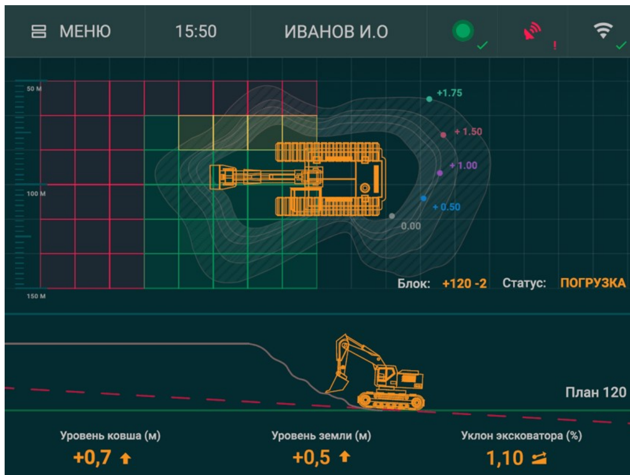
Рисунок .. Схема автоматизированной системы высокоточного позиционирования ковша экскаватора
