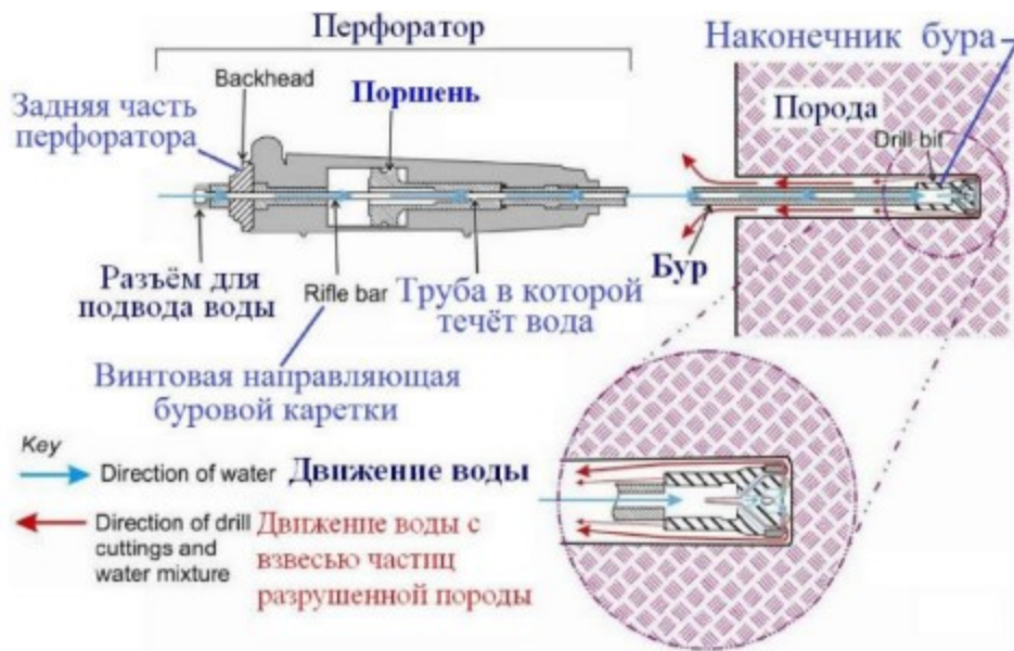
Рисунок .. Схема движения воды при мокром бурении скважин и шпуров ручными перфораторами
