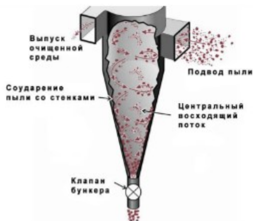
Рисунок .. Базовая схема устройства циклона
