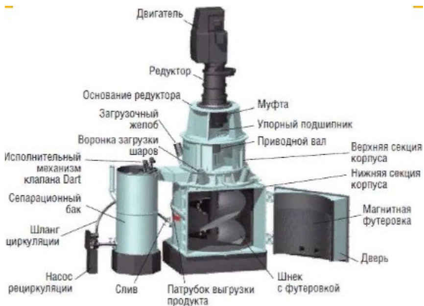
Рисунок .. Описание комплектующих мельницы Vertimill
