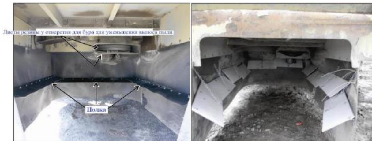
Рисунок .. Отклоняющие пылевой поток полки в ограждении
