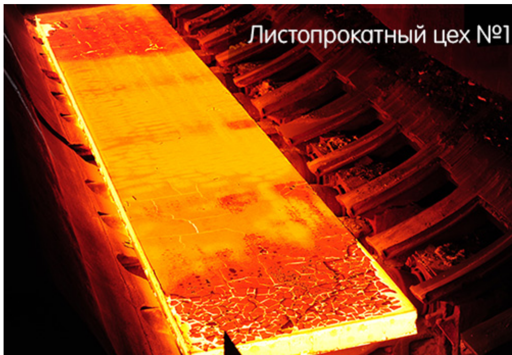
Рисунок 3.5. Выдача нагретых слябов в линию стана горячего проката
