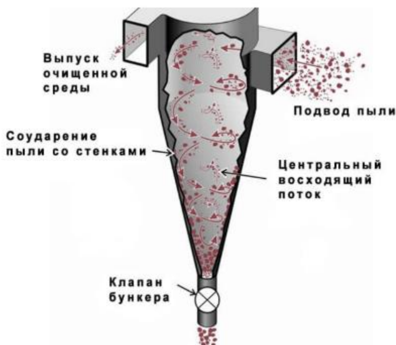
Рисунок 5.11. Базовая схема устройства циклона
