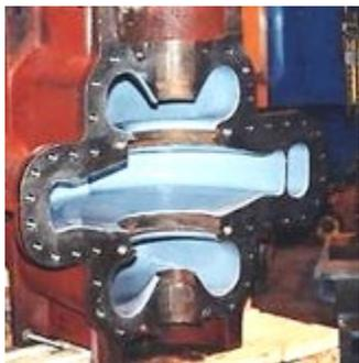
Рисунок 5.62. Вид обработанного гидрофобным покрытием корпуса насоса
