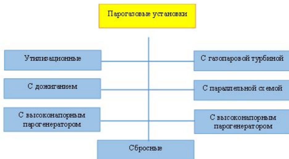
Рисунок 3.11. Классификация парогазовых установок по способам утилизации тепловой энергии выхлопных газов ГТУ
