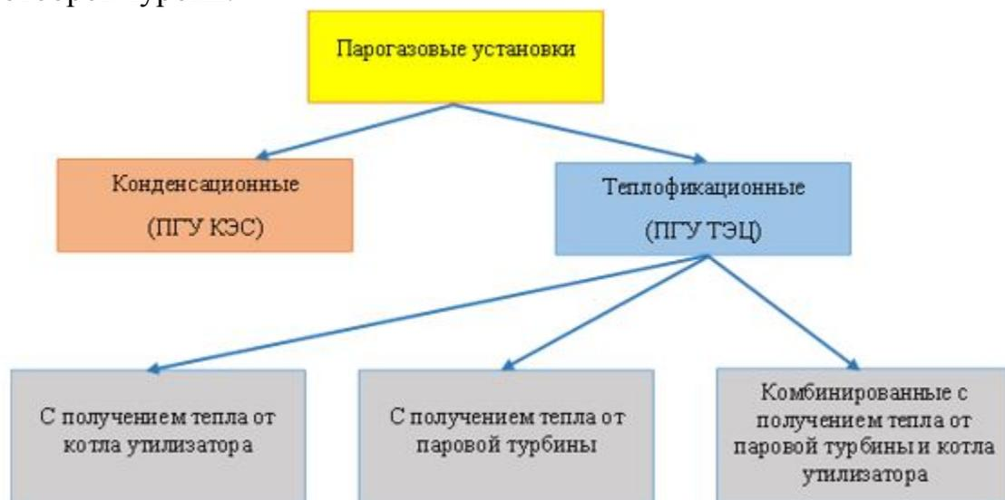
Рисунок 3.10. Классификация парогазовых установок по назначению
