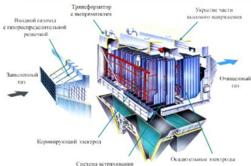
Рисунок 4.3. Общий вид стандартного сухого электрофильтра
