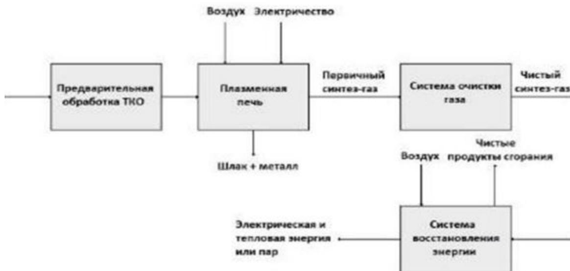
Рисунок 5.52. Блок-схема газификации ТКО с использованием плазменных источников энергии
