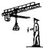
3. "ПЕРЕДВИНУТЬ КРАН (МОСТ)" - движение руки, согнутой в локте, ладонью по направлению требуемого движения крана (моста, стрелы).
