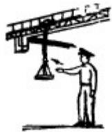
4. "ПЕРЕДВИНУТЬ ТЕЛЕЖКУ КРАНА, ПОВЕРНУТЬ СТРЕЛКУ" - движение руки, согнутой в локте, ладонью по направлению требуемого движения.
