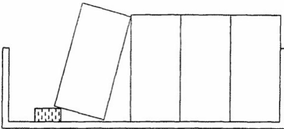
Рис.2 Схема расположения пакетов поперек кузова с применением бруска
