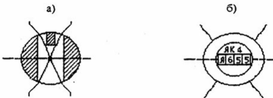
Рис. 2 Схема способа навешивания свинцовых пломб с камерой
