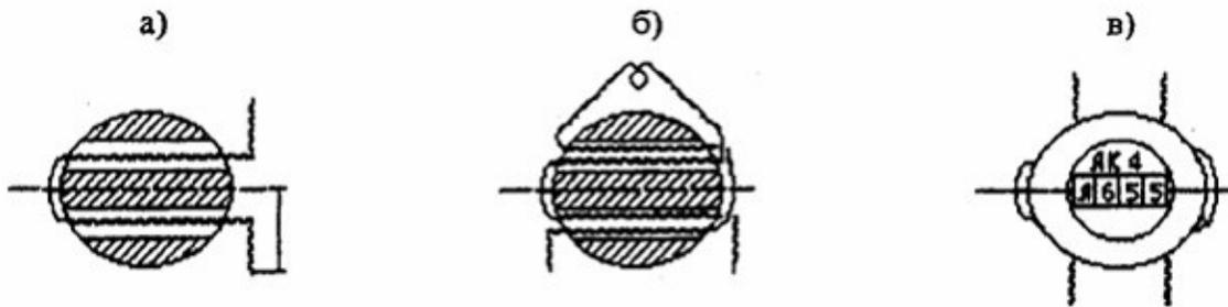
Рис. 1 Схема способа навешивания свинцовых пломб с двумя параллельными отверстиями
