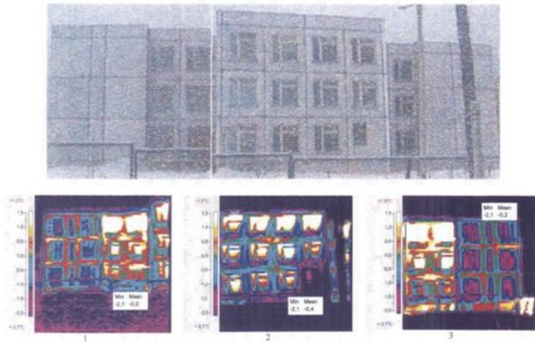
Рисунок 7. Термограмма ограждающих конструкций
