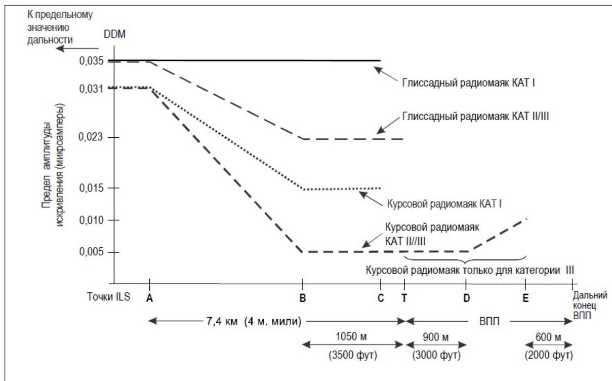
Рис. 1/29 Пределы амплитуды искривления курсовой линии КРМ и глиссады
