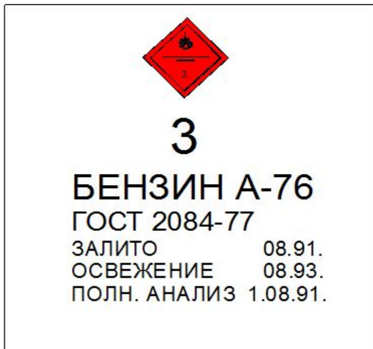
Рис. 6. Пример маркировочной таблицы для мягкого резервуара
